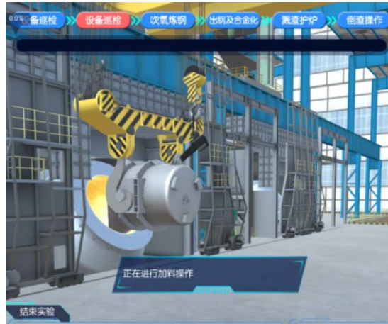
(j) 虚拟仿真实验中的兑铁水过程
