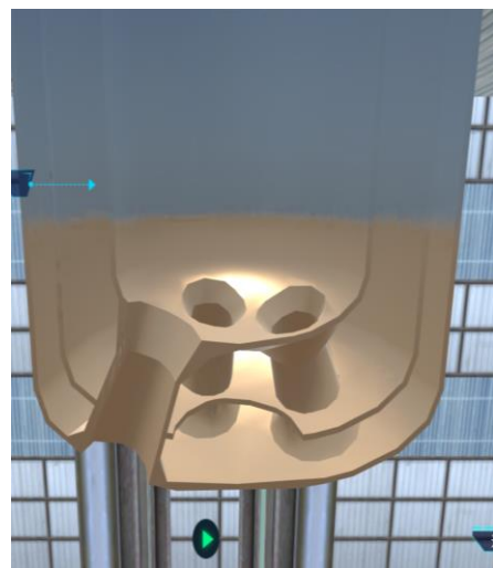
(f) 虚拟仿真实验中的氧枪喷头剖面
