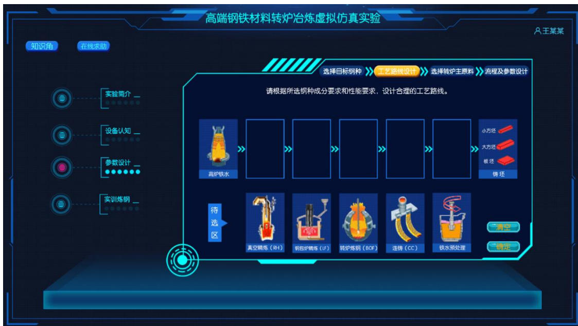
图 8 目标钢种选择及工艺路线设计
