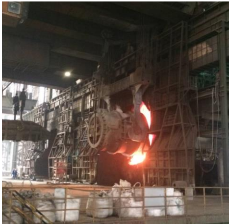
(i) 实际兑铁水过程
