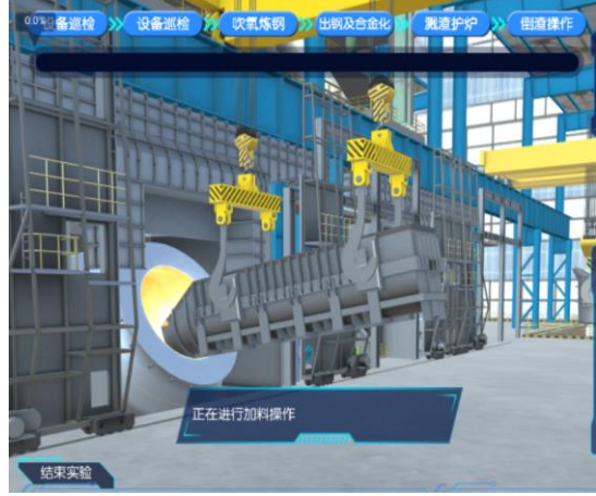
(h) 虚拟仿真实验中的加废钢过程
